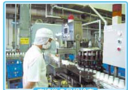
充填後の目視検査
